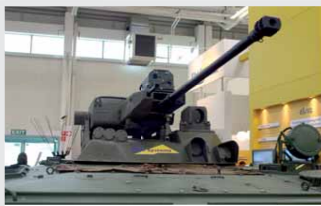
Vozidlo BVP-1 s novou věží Cobra II
