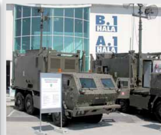
Jednou ze součástí nového slovenského mobilního komunikačního systému MOKYS je i radioreléová stanice na vozidle Tatra T815 6 × 6 s pancéřovanou kabinou.
