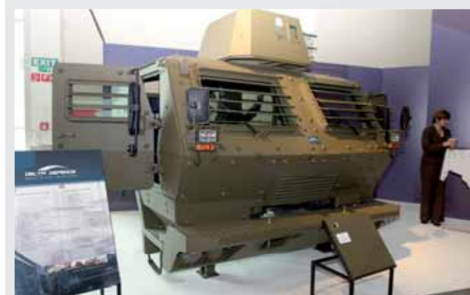
Pancéřovaná kabina DEL-KA pro vozidla Tatra
