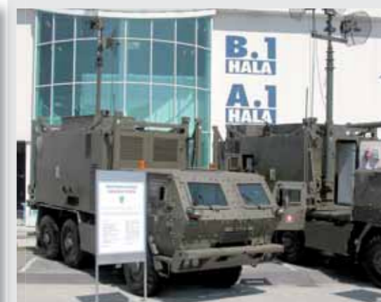
Jednou ze součástí nového slovenského mobilního komunikačního systému MOKYS je i radioreléová stanice na vozidle Tatra T815 6 × 6 s pancéřovanou kabinou.
