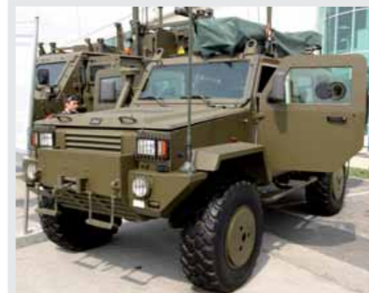
Nosnou platformou pro krátkovlnnou rádiovou stanici v rámci systému MOKYS je lehké kolové obrněné vozidlo RG-32M.
